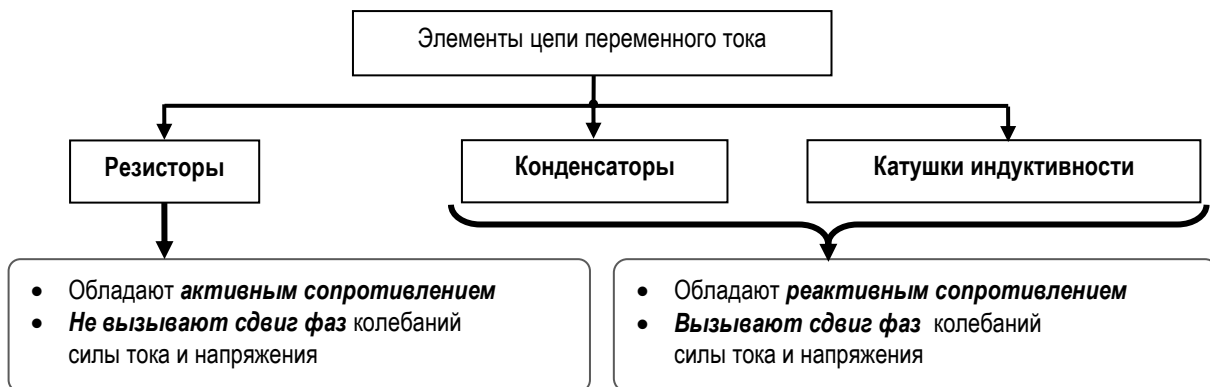
Рис. 4. Фрейм в виде блок-схемы, отображающий элементы цепи переменного тока
